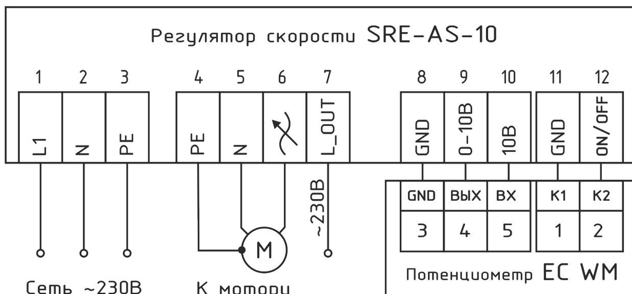
Рис. 2 Схема подключения регулятора скорости
