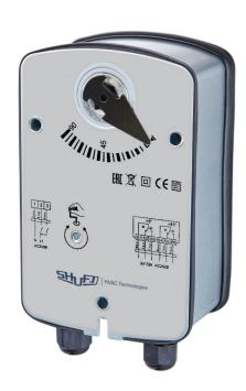
Энергоэффективный электропривод с функцией пружинного возврата. Используется для противопожарных клапанов с крутящим моментом до 10 Нм.
